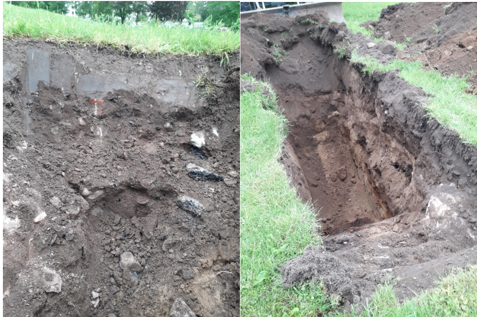
Figur 15. PG1. T.v. översta skikten innehållande tegelrester och asfalt. T.h. hela provgropen med fyllnadsmaterial och underlagande naturligt material.
