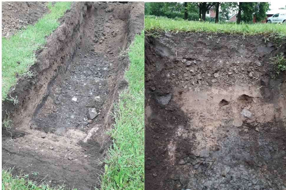
Figur 16. PG2. T.v. ses ett lager med finkornig fyllning och i botten ett lager innehållande bl.a. asfalt. T.h. översta lagren fyllnadsmaterial av varierande karaktär.
